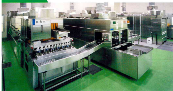
学校から戻ってきた食器・食缶・スプーン・箸・コンテナなどを洗います。
