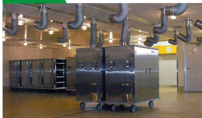
食器・コンテナなどを高温で消毒し、翌日まで保管します。
