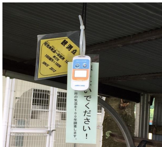
観測点に設置された連続観測温度計
