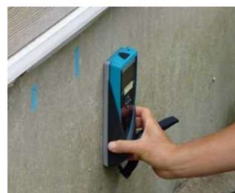
「基礎配筋」の調査機器
