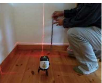
「床の傾きを計測する」調査機器
