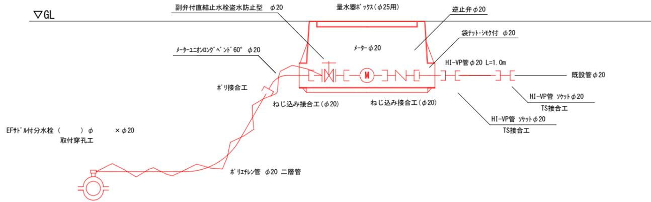
給水管 (メーターφ20) 設置工 (給水管PPφ20) 1箇所当たり
