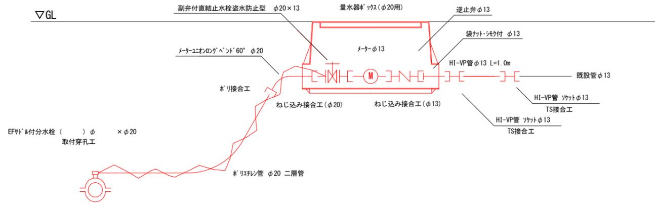
給水管 (メーターφ13) 設置工 (給水管PPφ20) 1箇所当たり
