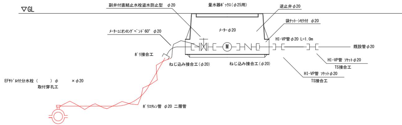
給水管 (メーターφ20) 設置工 (給水管PPφ20、φ25) 1箇所当たり
