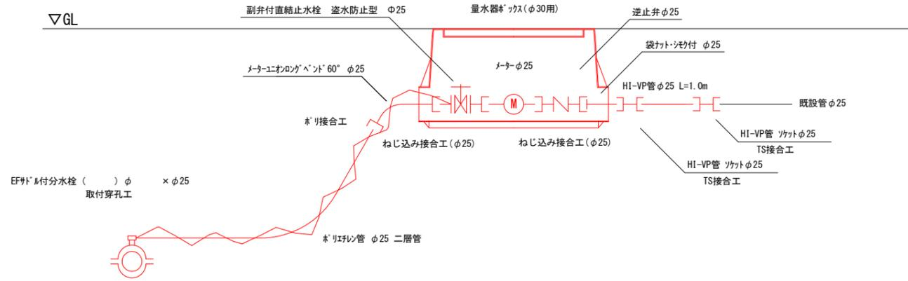
給水管 (メーターφ25) 設置工 (給水管PPφ25) 1箇所当たり
