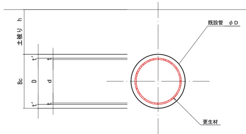
スーパーセラミック管(SS管) 形成工法 自立管
