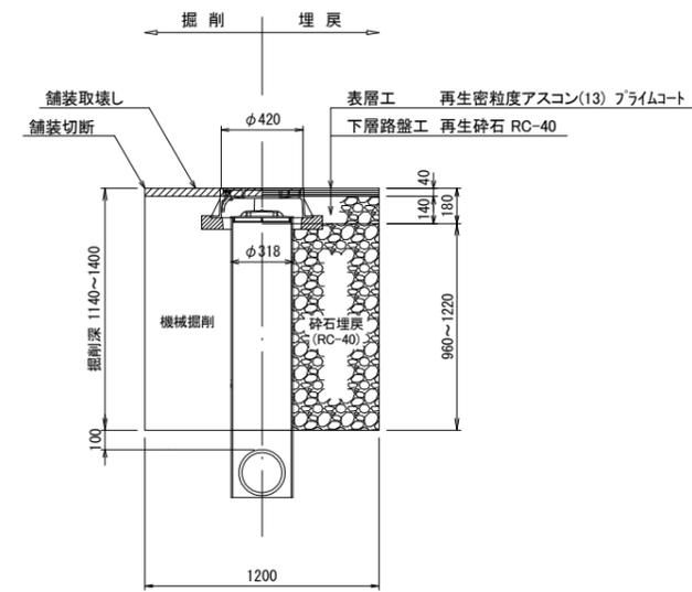
※掘削は既設砂埋戻しの上までとする。
