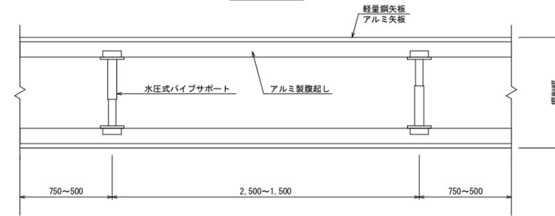
※支保工のスペンは掘削延長に応じて適宜調整する。
