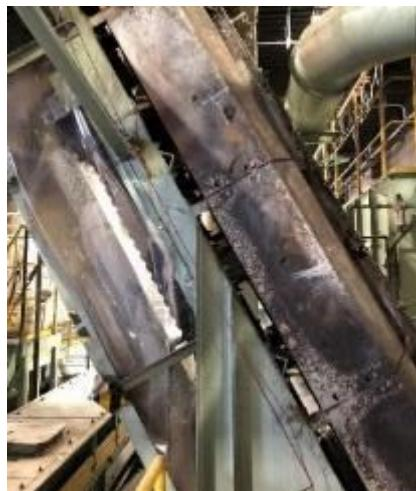
図 5-2 火災で焦げた破碎物コンベヤ
