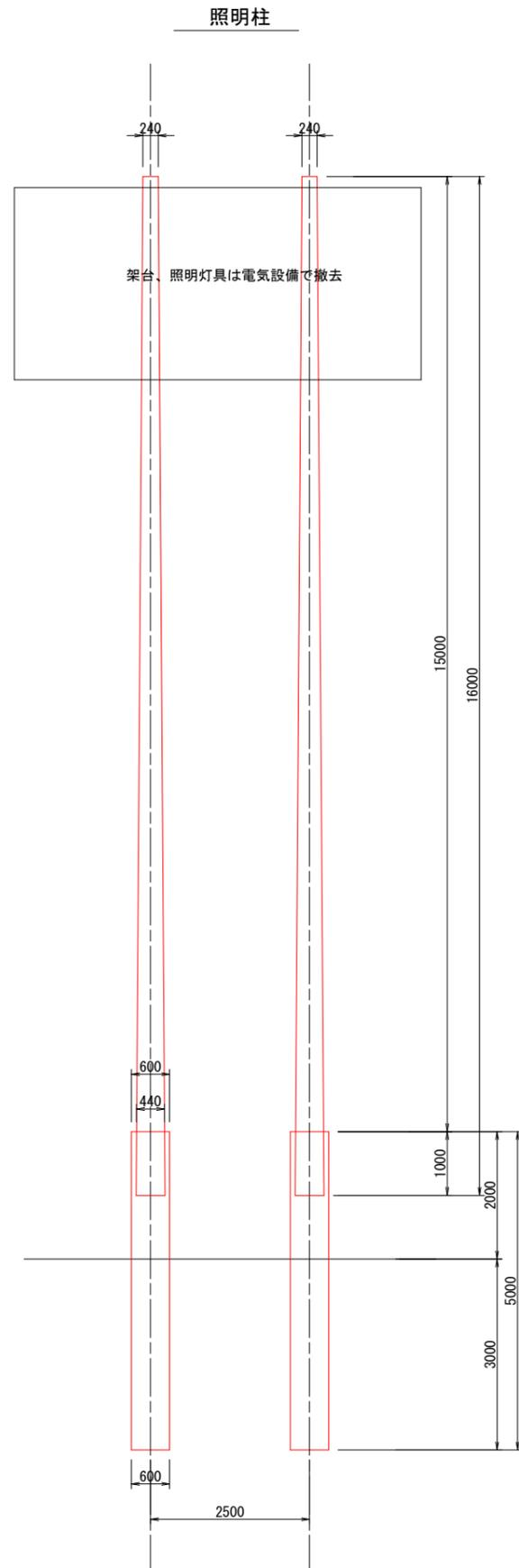
※照明柱 H=20.0m 東海コンクリート製 継20-24-15
