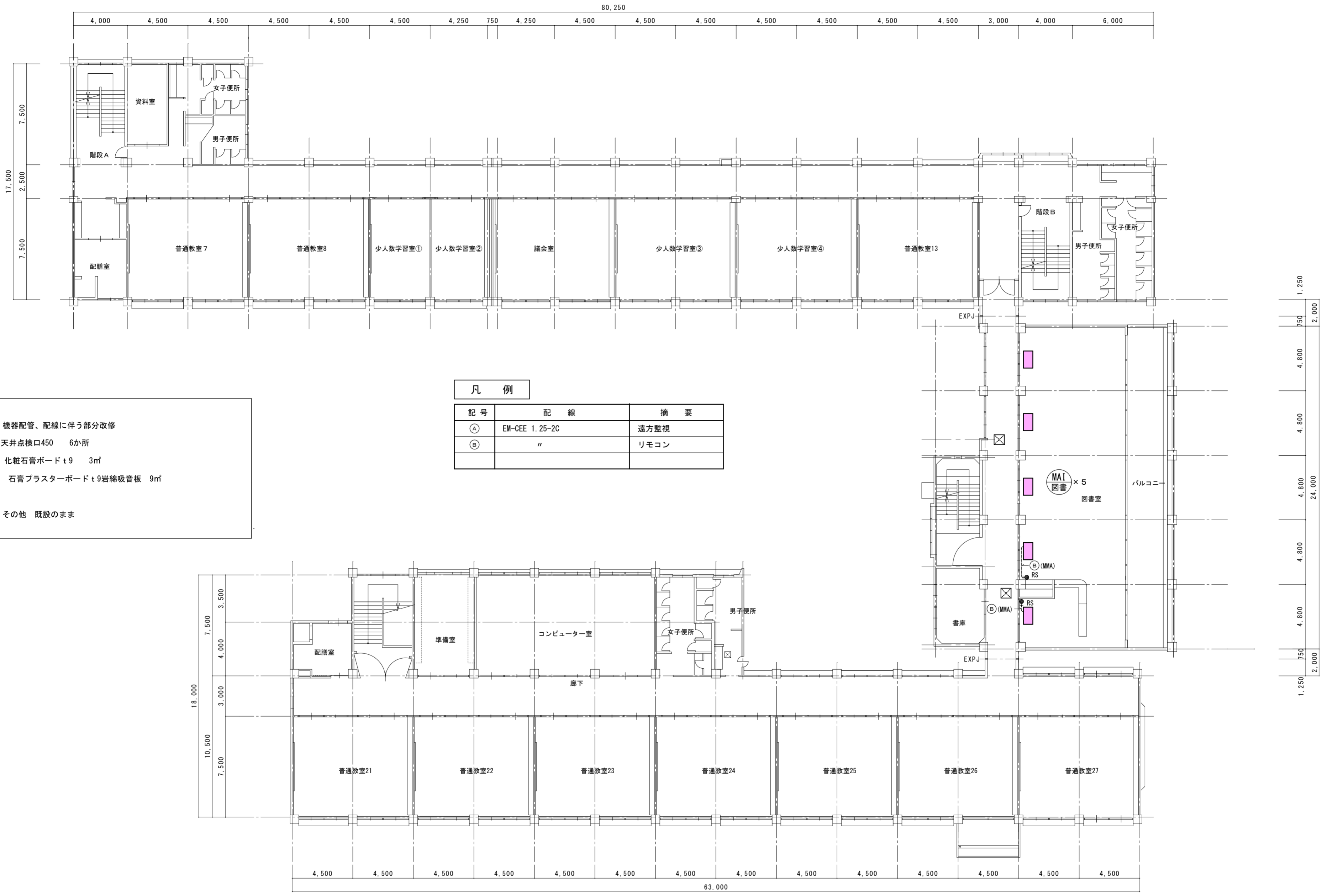
3階平面図 1/200 リモコンスイッチはリモコンカバー（鍵付き）内取付とする。
