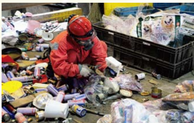
手作業で危険物を取り除きます
