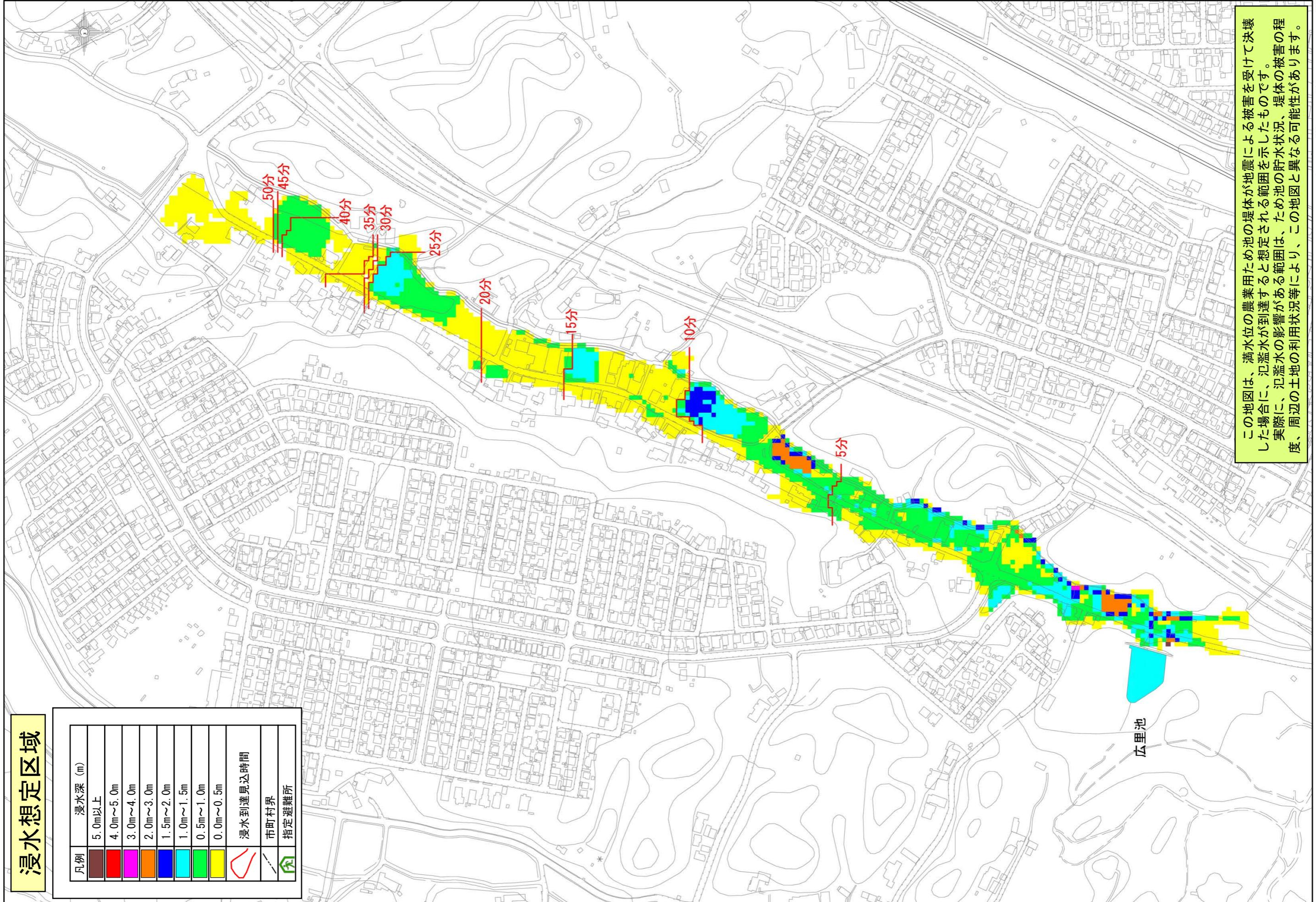
この地図は、満水位の農業用ため池が地震による被害を受けて決壊した場合に、氾濫水が到達すると想定される範囲を示したものです。実際に、氾濫水の影響がある範囲は、ため池の貯水状況、堤体の被害の程度、周辺の土地の利用状況等により、この地図と異なる可能性があります。
