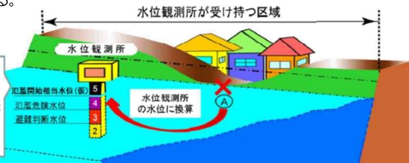
「氾濫開始相当水位」とは、河川の一連の区域で最も越水・溢水の可能性が高いと考えられる箇所において、堤防天端高（又は背後地盤高）など氾濫が開始する各箇所の水位を、その箇所を受け持つ水位観測所において換算した水位である（災対法改正により令和3年5月から導入）。
