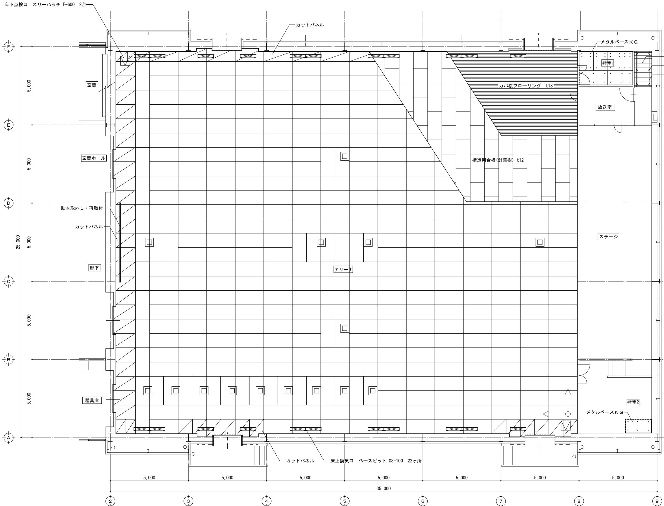
1階アリーナ 鋼製床割付図 S=1/100
