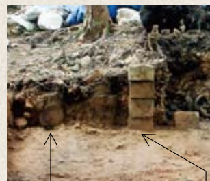
容器に粘土を詰めた柱(左)と粘土を角型に成形した柱(右)
