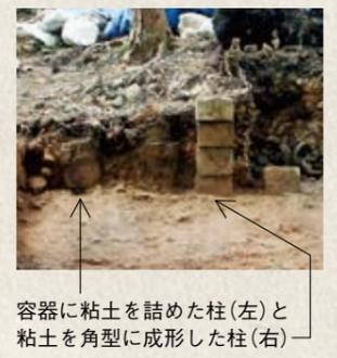
容器に粘土を詰めた柱(左)と粘土を角型に成形した柱(右)
